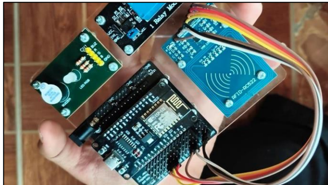
Gambar 1. Proses pengkabelan NodeMCU ke modul RFID RC522
