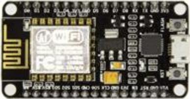
Gambar 3 Mikrokontroler NodeMCU
