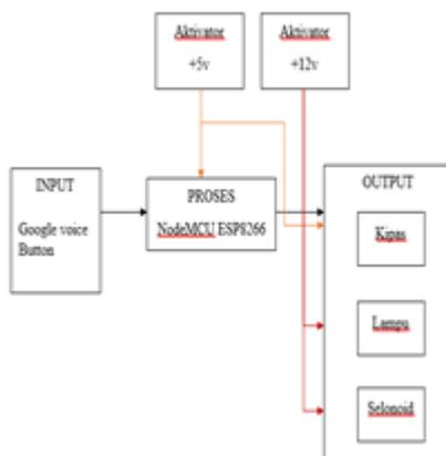
Gambar 1. Perancangan Blok Sistem
