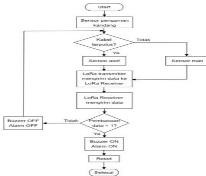
Gambar 2 Flowchart Cara Kerja Sistem
